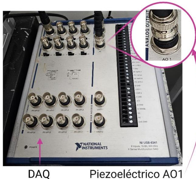
**Figura 4.11.1. Conexión del piezoeléctrico con la tarjeta de adquisición de datos (DAQ).** El piezoeléctrico está bajo el control del DAQ a través de la salida analógica AO1. A través de este canal el DAQ es capaz de enviar información desde el computador al piezoeléctrico, así es posible el control preciso de movimiento para ajustar la distancia del objetivo a la muestra, logrando un enfoque exacto. *Preparado en con BioRender.*
